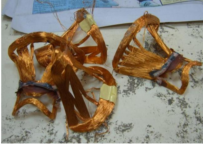
الشكل 15: نحاس مستخلص من مغناط أنبوب الأشعة المهبطية
